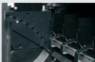
Focócelulas detección producto por reflexión
